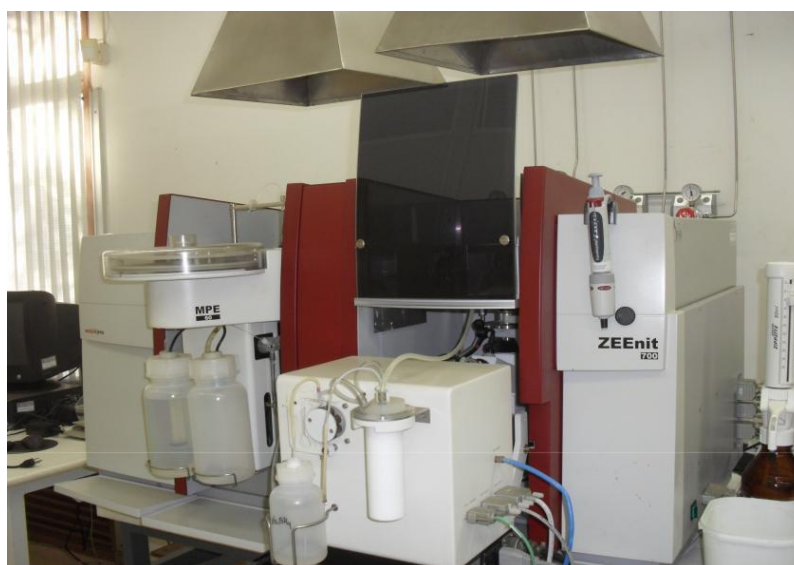
Figura 3 - Espectrômetro de absorção atômica com gerador de hidretos (HG-AAS), marca Analytik Jena, modelo Zeenit 700 localizada no LANAGRO/MAPA.
